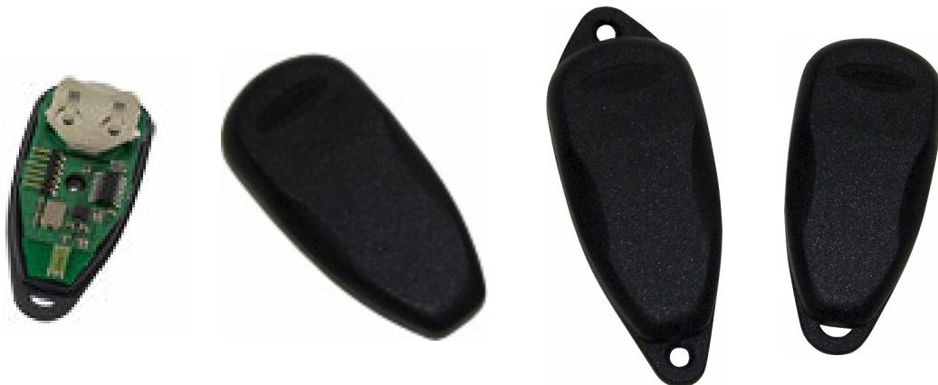
Метки предназначены для идентификации объектов различной физической природы и конструкции. Для удобства их использования каждая метка поставляется с тремя типами основания корпуса (для крепления на двухсторонней липкой ленте, для ношения на связке ключей, для крепления к объекту с помощью двух саморезов).
